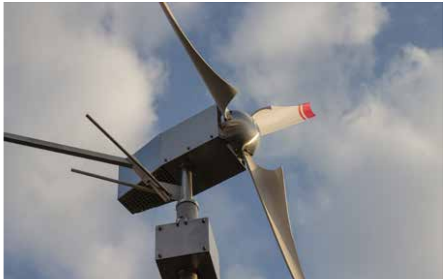
Abb. 6: Kompakte Umsetzung der Sturmsicherung Furling.
